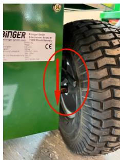
Per reinserire il freno, è necessario premere la leva verso il basso.
