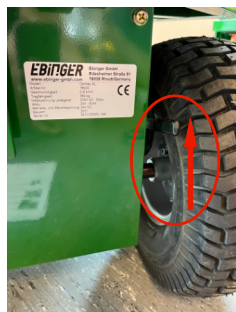
fig. 10 Leva alzata, apparecchio spento: possibilità di movimento manuale
