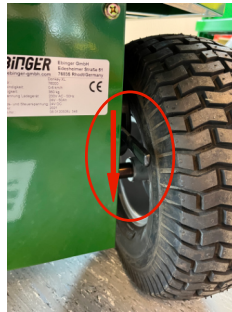
Um die Bremse wieder einzukuppeln, muss der Hebel nach unten gedrückt werden.
