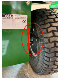
Para volver a accionar el freno, hay que presionar la palanca hacia abajo.
