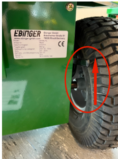
fig. 10 Palanca arriba, unidad apagada: movimiento manual posible
