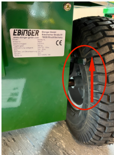
Abb. 10 Hebel nach oben, Gerät ausgeschaltet: manuelle Bewegung möglich
