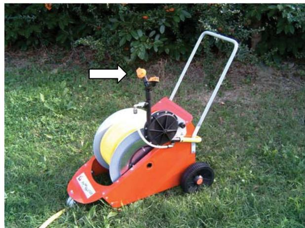
**9.** Durante l'irrigazione Passeggiando si muove sul tubo riavvolgendolo completamente. Qualora l'irrigatore sia fornito di dispositivo di arresto (accessorio) il contatto provoca la fine dell'irrigazione. Attenzione: la macchina termina l'irrigazione ma non arresta la pompa! Se la macchina non è fornita del dispositivo di arresto l'utilizzatore dovrà verificare periodicamente lo stato di avanzamento nel corso dell'irrigazione.
