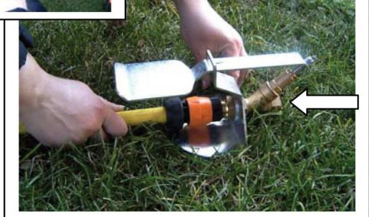
**6.** Esercitare una pressione nell'asta del dispositivo di arresto (accessorio) per permettere successivamente il passaggio dell'acqua. Collegare il dispositivo (o il tubo del Passeggiando) alla mandata dell' acqua.
