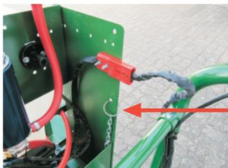
Stecken Sie zuerst den Ladestecker in die Ladebuchse am Spritzgerät und danach an die Stromversorgung.
