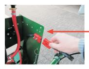
Stecken Sie zuerst den Ladestecker in die Ladebuchse der Elektroschubkarre und danach an die Stromversorgung.
