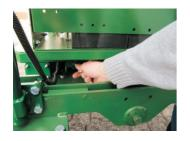
Zum Einschalten der Elektroschubkarre betätigen Sie den Hauptschalter, welcher auf der Seite der Lenkholme unterhalb des Sprühgerätes sitzt.
