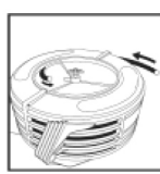
fig. 8 - mettre le nouveau tuyau en place
